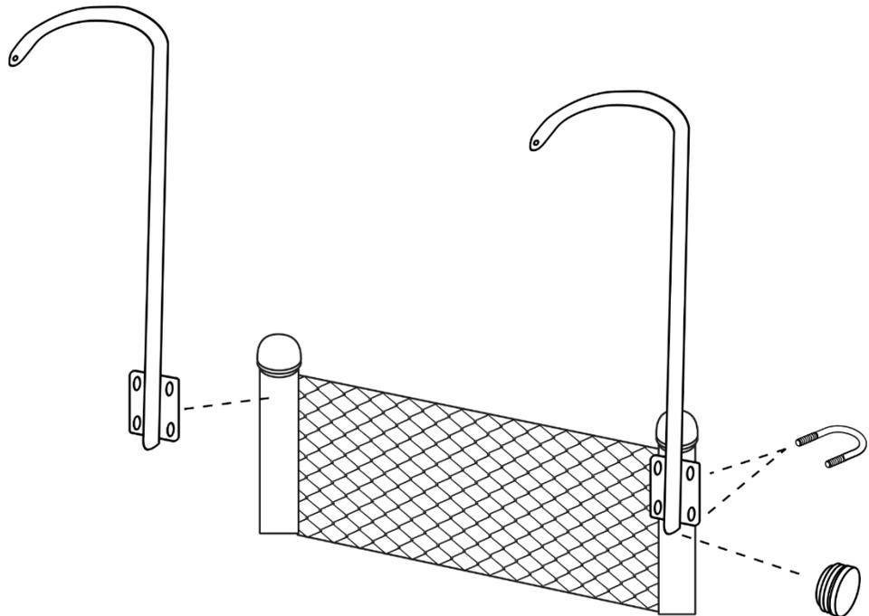
3. En el **INTERIOR** de su línea de vallado, comenzando en la punta soldada del primer **POSTE DE EXTENSIÓN (D)**, fije la **MALLA DE VALLADO (A)** a cada **POSTE DE EXTENSIÓN (D)** cada 12" a lo largo del poste utilizando las **BRIDAS AUTOBLOCANTES (B)**. Repita este paso para todos los **POSTES DE EXTENSIÓN (D)** restantes.
