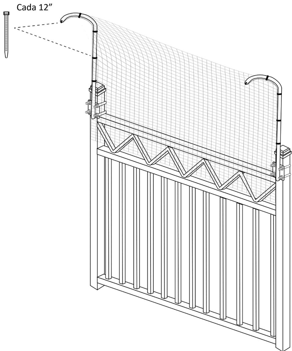
4. Fije la parte inferior de la **MALLA PARA VALLADO (A)** con **grapas (se venden por separado)** para vallados de madera/media altura/vinilo o con **bridas adicionales (se venden por separado)** para vallados metálicos decorativos y de eslabones de cadena.
