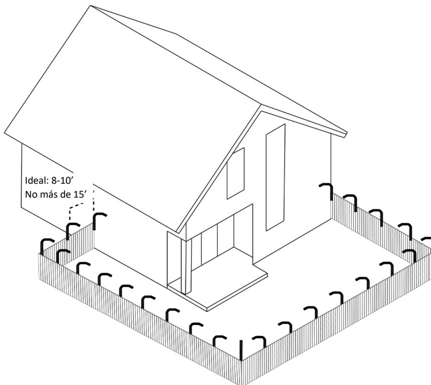
2. En el **INTERIOR** de su línea de vallado, fije los **POSTES DE EXTENSIÓN (D)** a los postes existentes de su vallado utilizando los **HERRAJES (E)** designados para su tipo de vallado. Monte la placa del **POSTE DE EXTENSIÓN (D)** por lo menos 2" por debajo de la parte superior de su poste existente. Una vez montado inserte la **TAPA DE VINILO (C)** en la parte inferior abierta del poste de extensión.
