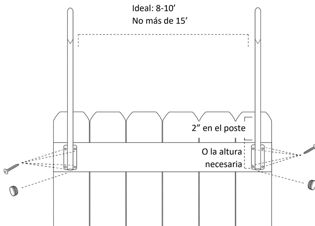
**Nota:** Los herrajes dependerán del kit que haya adquirido. Puede montar el **POSTE DE EXTENSIÓN (D)** a diferentes alturas para adaptarlo a sus necesidades específicas.
