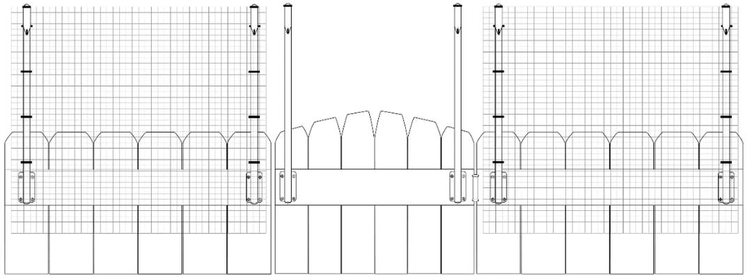
2. Utilizando una sección de **MALLA PARA VALLADO (A)** cortada a la medida de la puerta, fije la **MALLA PARA VALLADO (A)** al **POSTE DE EXTENSIÓN (D)** de la puerta cada 12" a lo largo del poste utilizando las **BRIDAS AUTOBLOCANTES (B)**.
