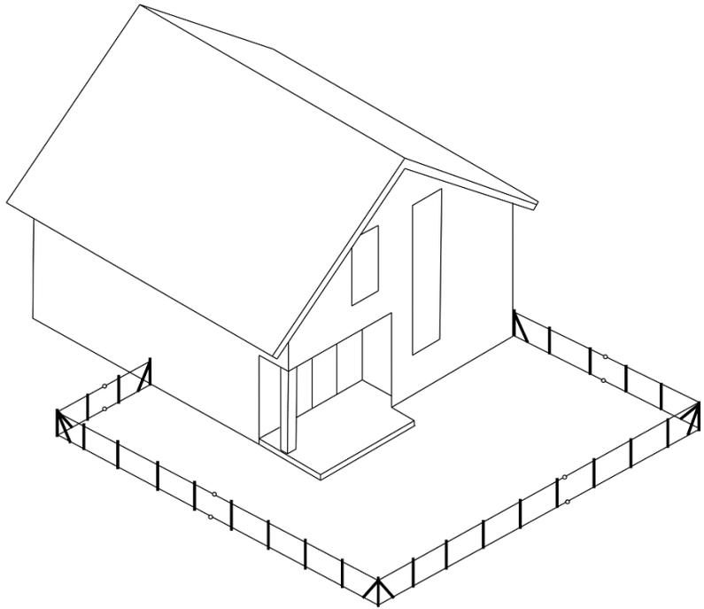
6. Por último, a medida que instale la malla de la valla, fije la malla al **CABLE MONOFILAMENTO (A)** superior e inferior usando su **ALICATE DE ARGOLLA (E)** y cerrando las **ANILLAS DE SUJECIÓN (F)** cada 1' a lo largo de la línea de la valla.
