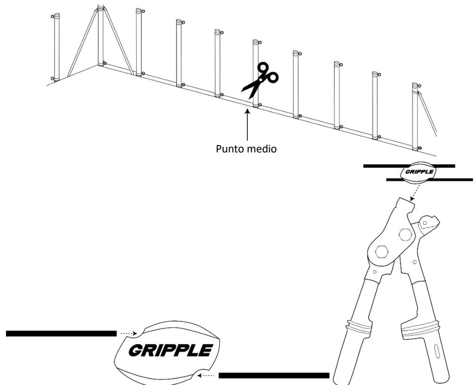
5. Repita los **PASOS 2-4** para la parte superior e inferior del sistema de vallas y todos los lados del sistema.
