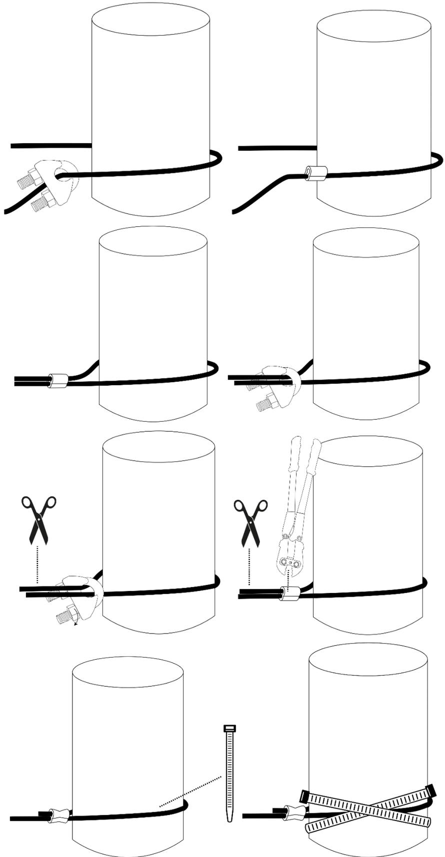
3. Desde el punto de arriostamiento, pase el extremo del **CABLE MONOFILAMENTO (A)** a través de cada **BANDA DE ALINEACIÓN (G)** hasta llegar al siguiente poste de sujeción o punto de terminación, es decir: esquina, extremo o poste de puerta. Debe haber un poco de holgura en el cable. Repita el **PASO 2** para terminar el **CABLE MONOFILAMENTO (A)** en el siguiente poste de sujeción y comience su siguiente tramo.
